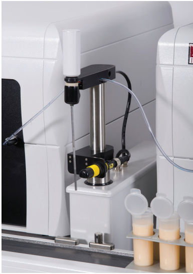
Автоматизована система відбору проб для лабораторій з великою кількістю зразків
