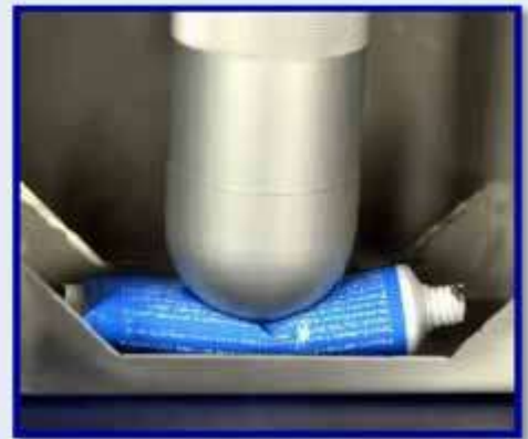
ТСТ-2 для испытания тюбиков (с дополнительным приспособлением)
