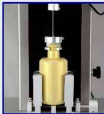
Испытание на проталкивание-вытягивание
