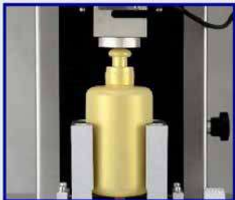
Испытание на проталкивание-вытягивание
