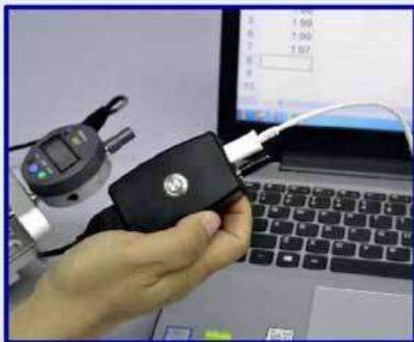
Блок передачи данных измерительного датчика GDTB-1 - это блок обработки данных, специально разработанный для сбора данных с цифровых датчиков измерения Mitutoyo и отправки непосредственно на ПК. С GDTB-1 оператору просто нужно нажать кнопку, чтобы передать данные с любых цифровых датчиков измерения Mitutoyo во множество файлов на ПК вместо ввода с клавиатуры, доступно для файла «Word», файла «Excel», файла «txt» и т. Д. Это будет намного эффективнее и поможет избежать опечаток.
