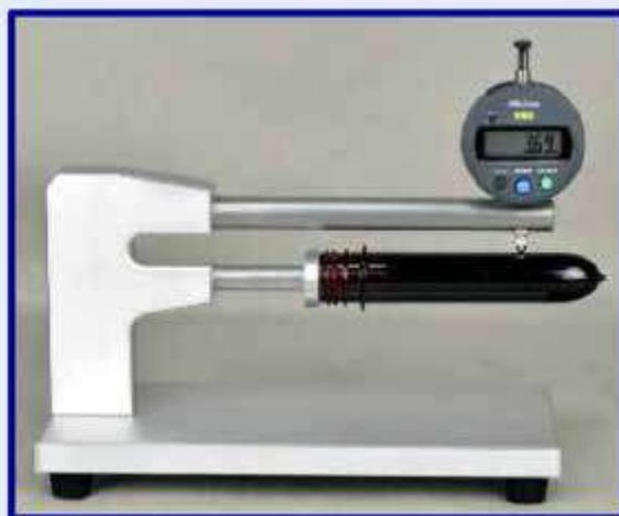
Измеритель толщины заготовки РТГ используется для измерения толщины заготовки.
