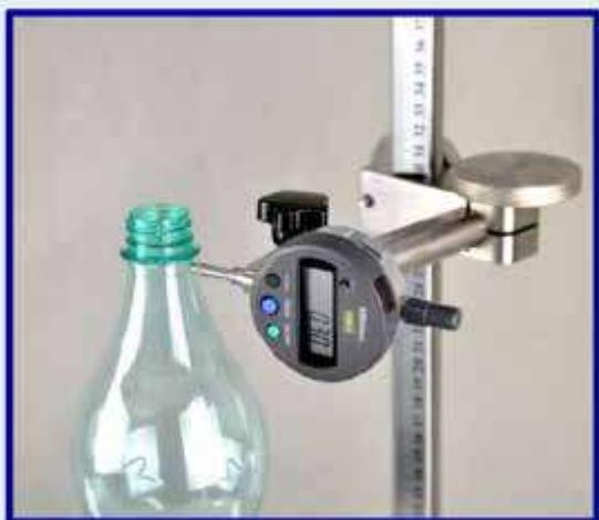
Линейка позволяет точно измерять положение
