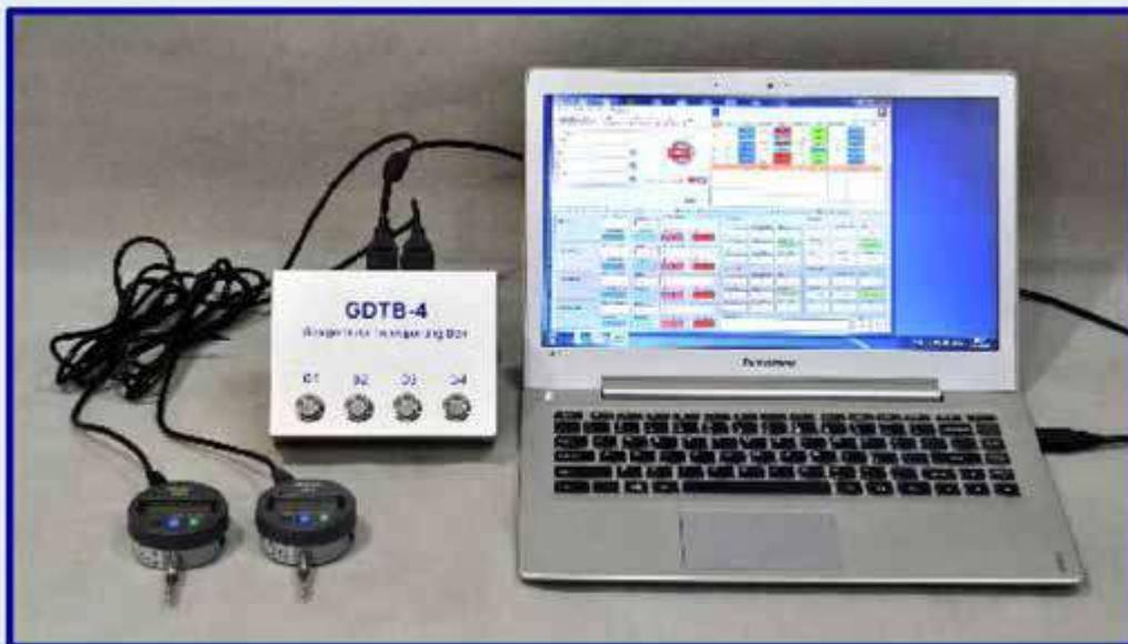
Блок передачи данных измерительного датчика GDTV-4 - это блок обработки данных, специально разработанный для сбора данных с цифровых датчиков измерения Mitutoyo. С помощью GDTV пользователи могут собирать данные цифровых датчиков измерения Mitutoyo и отправлять их в систему сбора данных или на ПО QUALIGAUGE компании AT2E. Возможность подключения до 4-х датчиков измерения.
