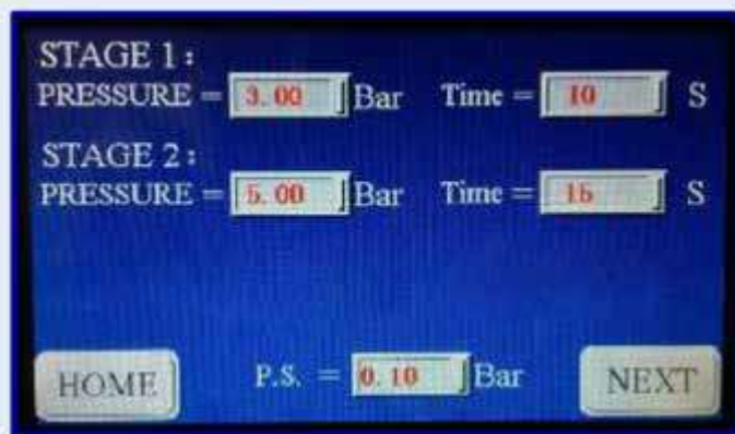
Интерфейс настройки давления и времени выдержки
