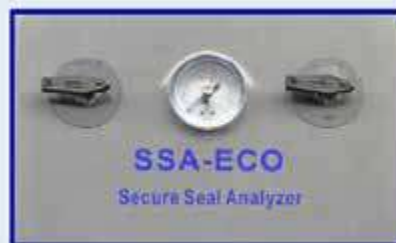
Регулирующий клапан и аналоговый дисплей
