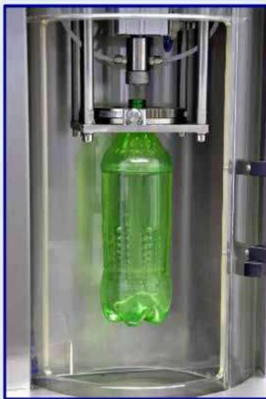
Измеритель прочности ПЭТ-бутылок на разрыв RBVT-ECO - это специализированное испытательное оборудование для испытания сопротивления внутреннему давлению ПЭТ-бутылок. Он обеспечивает функцию испытания ПЭТ-бутылок под высоким давлением и быстрым нагнетанием давления. RBVT-ECO способен проверить способность к упругой деформации при определенном давлении или испытании прочности ПЭТ-бутылки на разрыв.
