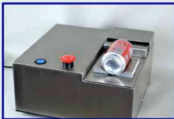
Дополнительная отрезная пила для шовного соединения: ANSS и SS-1
